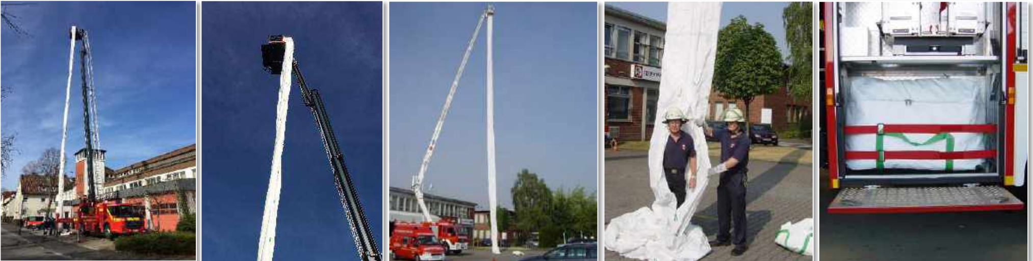
Mobiler Personenrettungsschlauch für Höhenrettungsfahrzeuge – beschleunigte Höhenrettung
